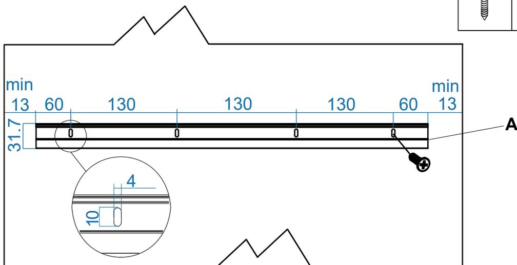
Сделайте разметку и зафиксируйте крепежную планку А винтами.
