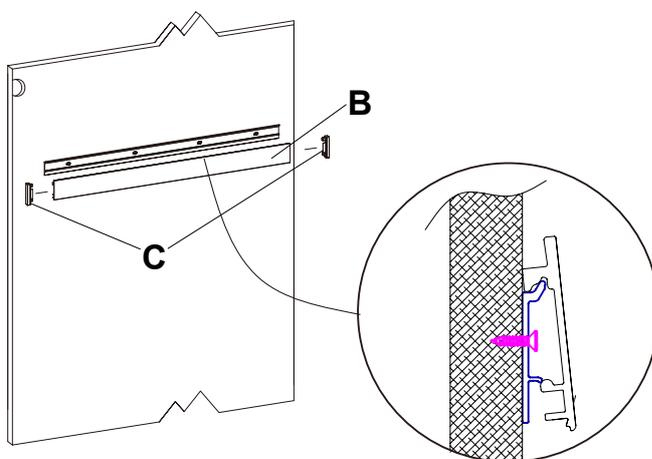
Нажмите на профиль В для его фиксации на крепежной планке А. Установите заглушки С.
